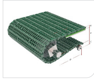
Typ: HS-F1000B Teilung: 25.4 MM Dicke: 8.6 MM Offene Fläche: 42%
